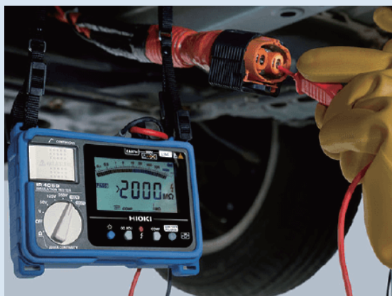
高压电池侧 (上图) 和逆变器侧 (下图) 的绝缘测试
