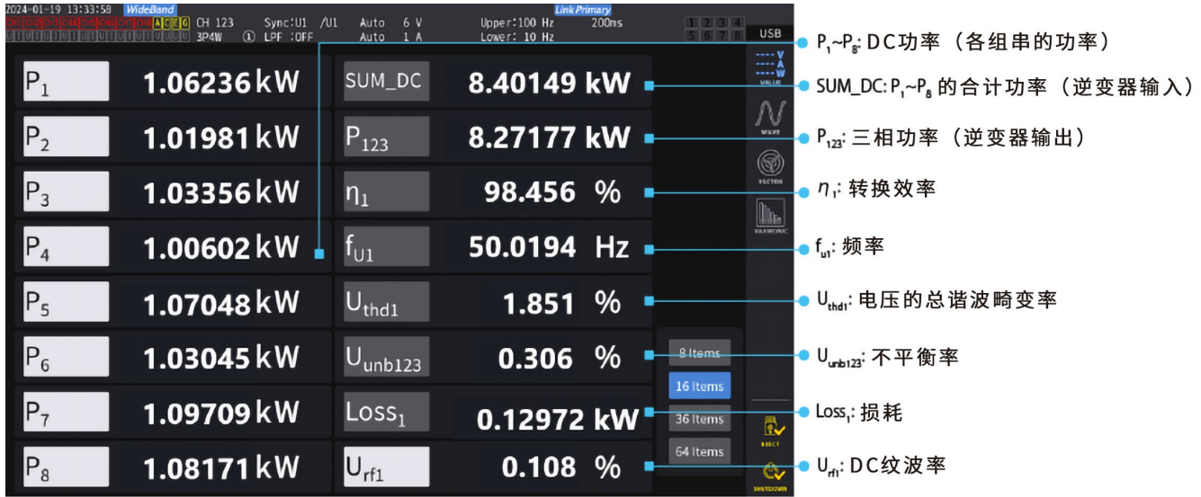
图 1 显示了利用光通讯同步功能测量 8MPPT 输入、三相输出变频器效率的示例。
