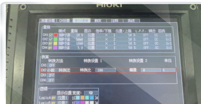
在MR8880的通道设置界面设置CM7290上显示的对应转换比
