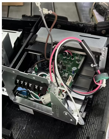
被测物(空调外机基板)
