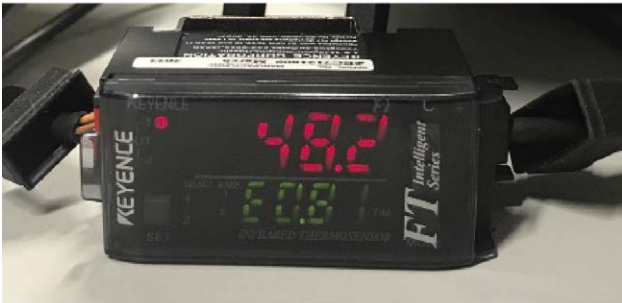
图1 红外温度传感器的放大器（基恩士公司）
