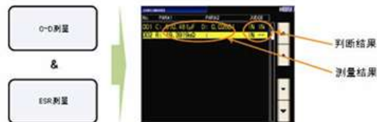
连续测量功能的测量、判断例
