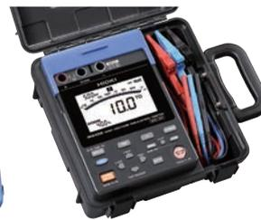
电子式绝缘电阻表
