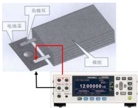
极耳焊接测试示意图
