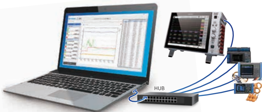
通过 LAN 连接各个测量仪器
