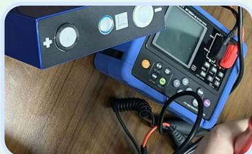
使用**电池测试仪BT3554-50搭配无线适配器Z3210以及针型测试线L2020**
