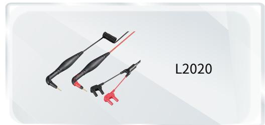
②四线制的测试方式原理为通过两条测试线施加恒定电流,另两条测试线则用于测试电压变化,以此排除了线阻对测试值的影响,大大提高了测量微小电阻时的精度。
