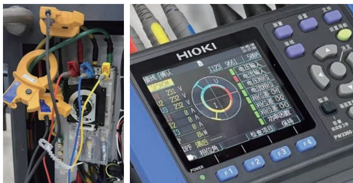
2 仅钳形功率计PW3365~30支持非接触式的电压测量
