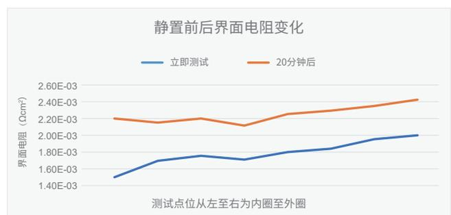
通过界面电阻的变化曲线可以分析得到,敷料层的反弹速率以及反弹量都呈现出相对稳定的变化,由于测试数据与敷料层内部结构的分布均匀程度和一致性同样相关,因此具体情况还需结合多种因素共同分析。
