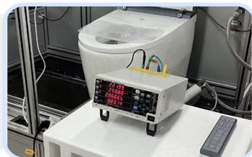
使用功率计PW3335搭配定制接线盒，根据上述标准，附录A.2中规定需要持续测试1.5h，因被测物由220V工频交流电供电，故电压量程选择300V，根据被测物满载运行时功率约1kW，计算得到电流量程选择5A即可。
