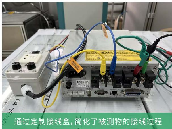
\*日置可根据客户所需不同的接线方式定制接线盒，以简化接线过程。
